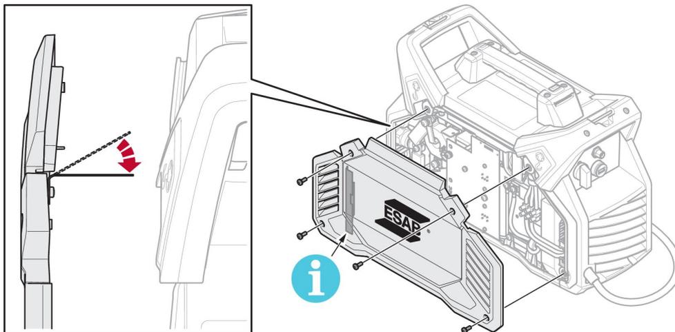
8. Serrer les vis sur les panneaux latéraux à un couple de  $3 \text{ Nm} \pm 0,3 \text{ Nm}$  ( $26,6 \text{ lb-po} \pm 2,6$ ).
