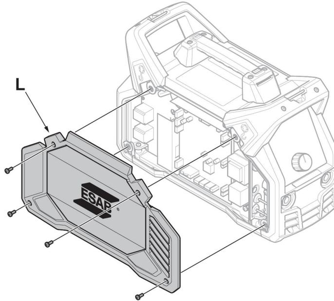
5. Nettoyer le côté gauche du générateur avec de l'air comprimé sec à pression réduite.
