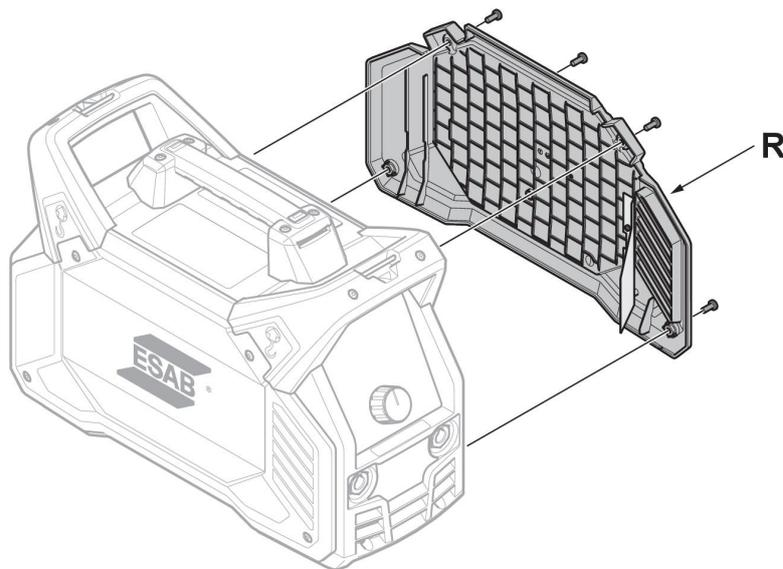
3. Nettoyer le côté droit du générateur avec de l'air comprimé sec à pression réduite.
